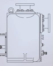
Flows To:1,400 GPMHeads To:200 FeetSolids To:1.25" DiameterTemps To:180° F
